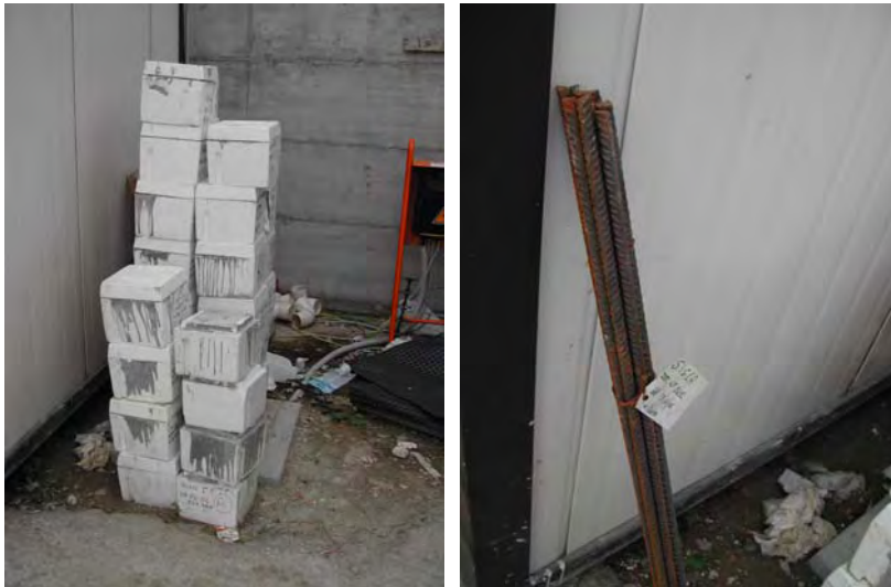
Cubetti di calcestruzzo prelevati e barre, pronti per essere testati in laboratorio.
